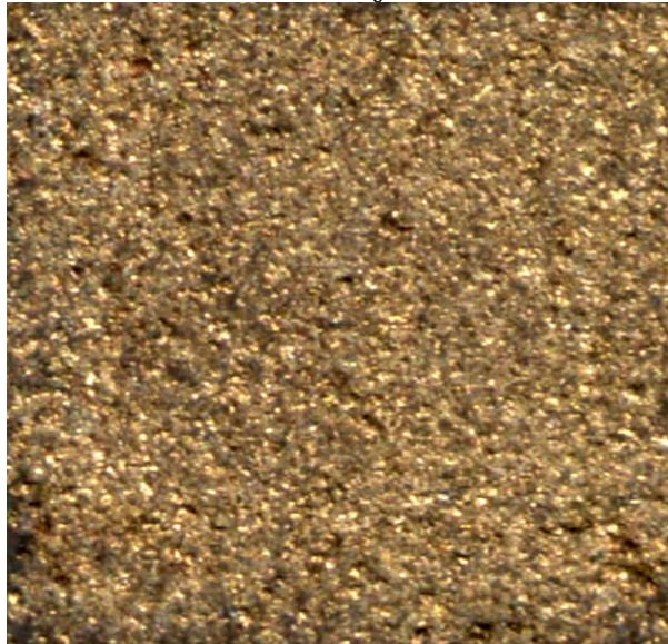
Figura 5. Strat obținut prin metoda depunerii pulberilor metalice prin descărcări electrice în impuls cu rupere de contact (Catod – oțel-45; Anod – BrOȚS-5-5-5. Pulberi metalice BrA-7. Imagine mărită × 20.)
