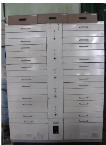
Figura 2. Instalație de uscare cu raze infraroșii
