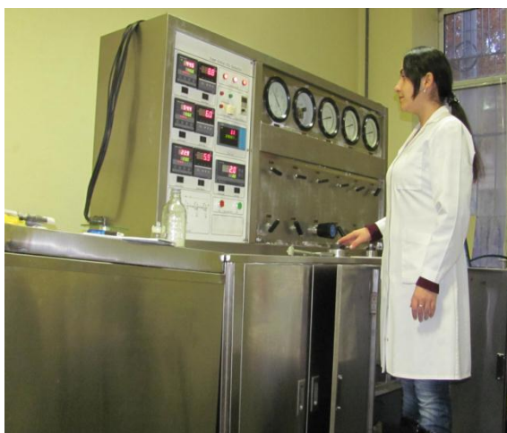
Figura 6. Instalația pentru extracția supercritică de tip HA 120-50-01C.
