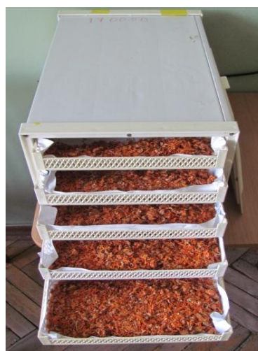
Figura 3. Deșeurile de tomate uscate la deshidratorul de tip Biosec Domus B5
