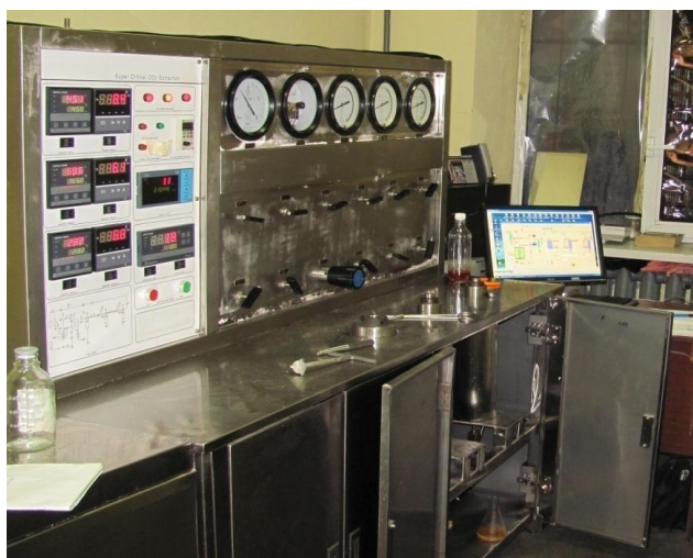
Figura 1. Instalația pilot de tip HA 120-50-01C pentru CO 2 -extracția supercritică
